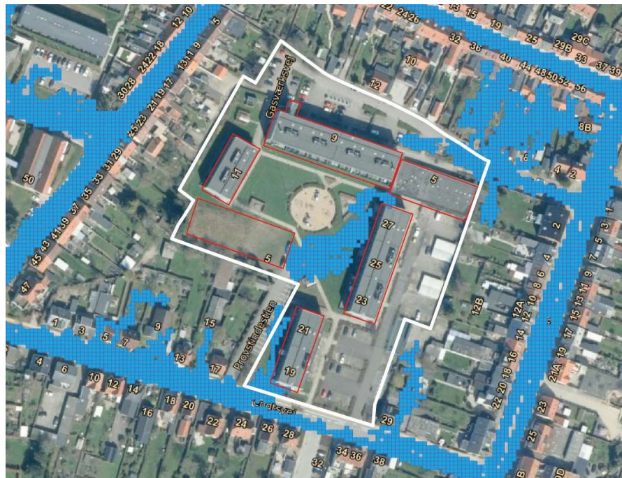
Figur 21 Dynamiske modelberegning, der viser vand (blå farve) på terræn ved skybrud (100-års hændelse i år 2100), hvor beregningerne også omfatter kloaksystemet. Planområdet er vist med hvid streg og byggefelter er vist med rød streg.
