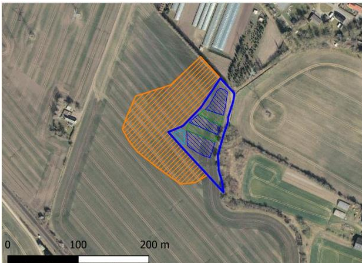
Figur 3: Skitse af projektarealet. Minivådområdeareal med blåt med markering af bassiner. Placering af overskudsjord vist med orange.
