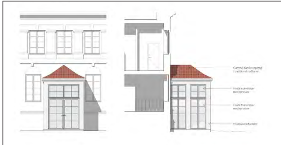
Figur 10: Facadeopstalt, der viser princip for udformning af et nyt indgangsparti.
