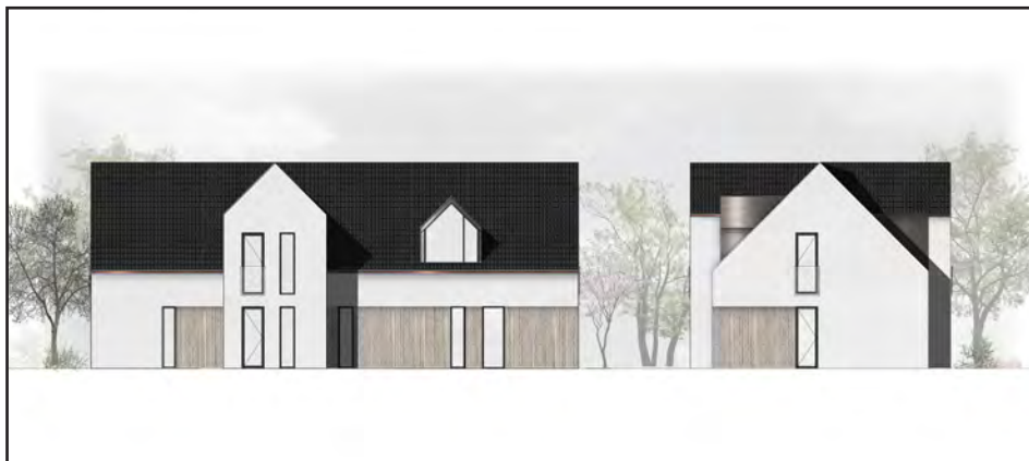
Figur 3: Princip for udformning af for facade (Byggefelt B) mod vest langs Teglgårdsvej samt gavlfacade mod syd.
